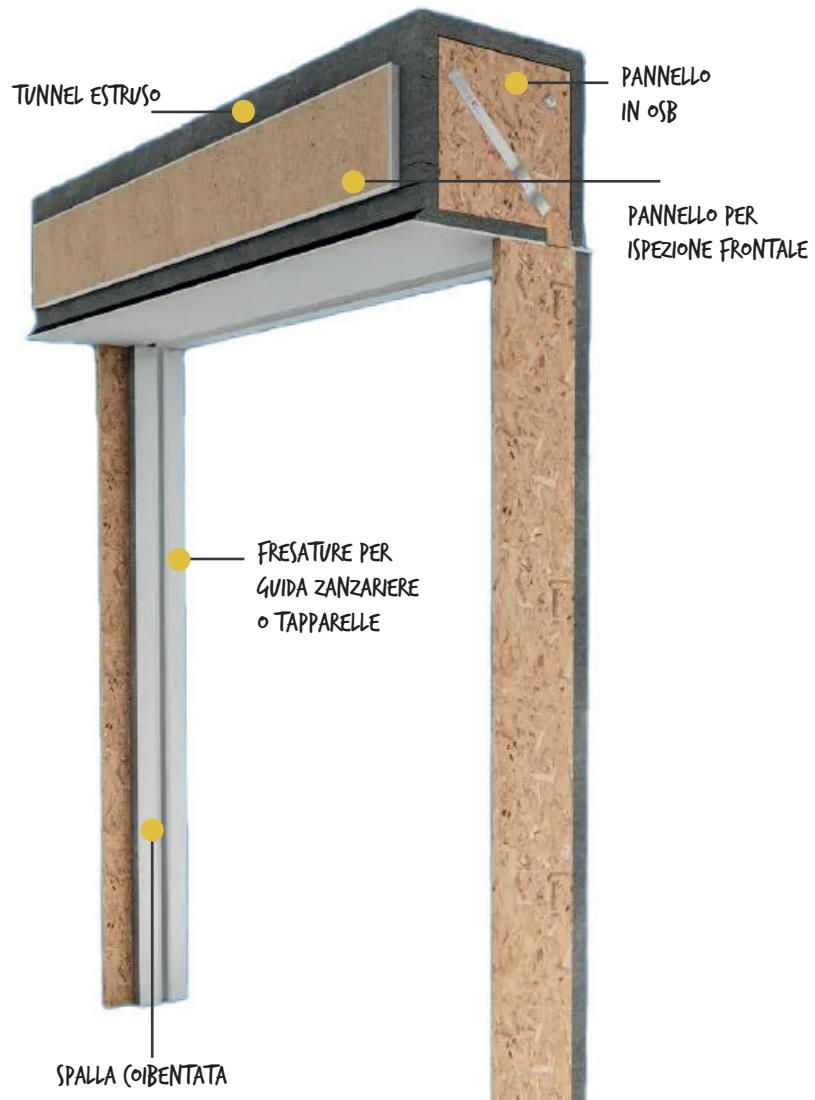
**Pratico e funzionale**, questo cassonetto con ispezione a tampone frontale e spalla integrata garantisce facilità di manutenzione, ottimo isolamento termico/acustico e un design discreto che si adatta perfettamente a nuove installazioni e ristrutturazioni.
