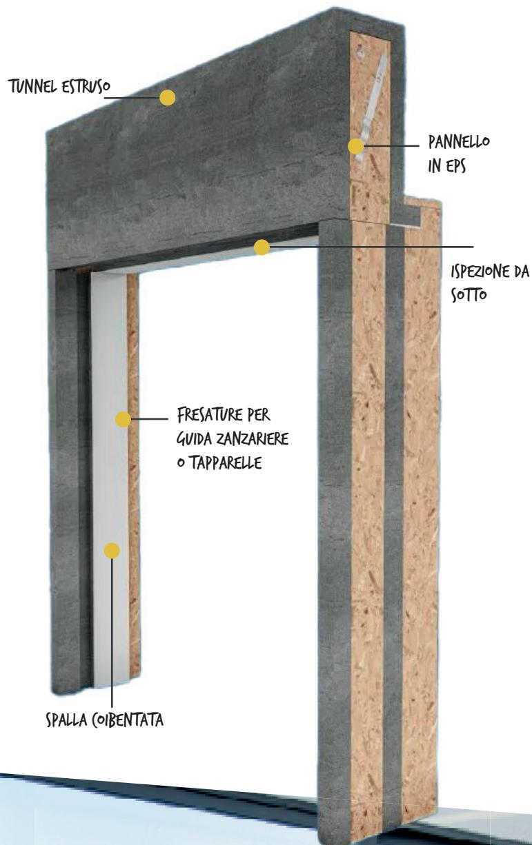
Soluzione ideale per l'**alloggiamento a scomparsa dei frangisole**, questo cassonetto con spalle laterali assicura stabilità, isolamento e un'integrazione armoniosa nell'infisso, garantendo praticità e un design pulito.
